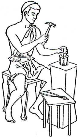
Figura 11. Recreación de la forma de fabricación de moneda en la que un solo operario coloca el cospel y lo acuña (tomado de CONOPHAGOS et alii)
